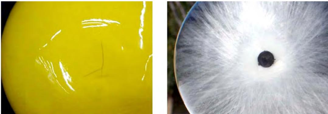
**Fissures autour de l'étiquette :** des petites fissures circulaires peuvent apparaître dans le revêtement superficiel en résine autour de l'étiquette. Etant donné que l'étiquette est sous la dernière couche de fibre de verre, cette zone est légèrement en relief. De temps à autre, des fissures de la résine superficielle se produisent en bordure de l'étiquette. Cela n'affecte pas l'intégrité de la bouteille et aucune remise en état n'est nécessaire.
