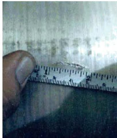
Veiller à ce que la surface soit propre et sèche. Couper toutes les fibres de verre détachées. Frotter légèrement la zone endommagée avec du papier de verre fin ou un tampon Scotch-Brite® pour que la surface permette une bonne adhésion de la résine.
