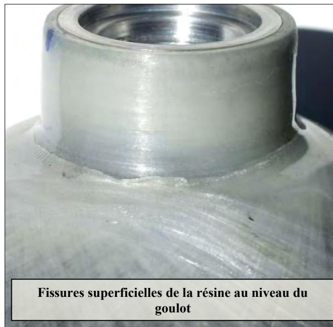
**Fissures superficielles de la résine au niveau du goulot**
