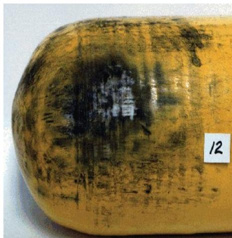
**Figura 6: Daño por calor o fuego**
