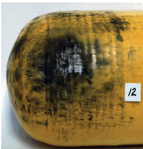
Figur 6: Varme- og brannskade
