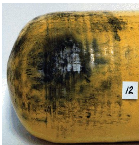
Abbildung 6: Hitze- oder Brandschäden
