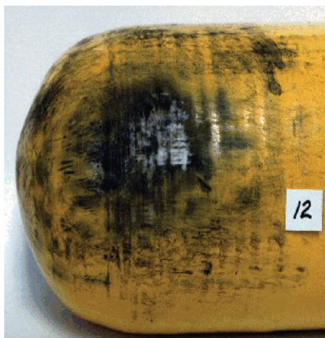
Afbeelding 6: Hitte- en brandschade
