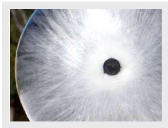
**Risse am Flaschenetikett** – Im Bereich der Flaschenkennzeichnung können feinste Haarrisse in der äussersten Harzbeschichtung auftreten. Da das Etikett unter der letzten Glasfaserschicht liegt, ist dieser Bereich geringfügig erhöht. Gelegentlich treten oberflächliche Risse im Harz an der Kante des Etiketts auf. Diese beeinträchtigen die Funktionstüchtigkeit der Gasflasche nicht. Es ist keine Reparatur erforderlich.
