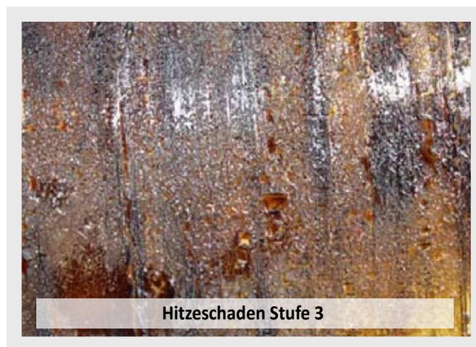
**Schadenstufe 3** (siehe oben stehendes Bild) ist ein Schaden, der dadurch verursacht wurde, dass die Gasflaschen stark erhöhten Temperaturen und/oder einer offenen Flamme ausgesetzt wurde; Flaschen dieser Schadenstufe müssen *ausgesondert* werden.
