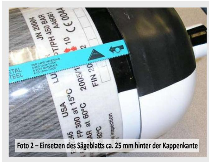
Nachdem das Sägeblatt zwischen die Gasflasche und die Kappe um den Umfang der Gasflasche geführt wurde, kann die Kappe entfernt werden. Heben Sie die Kappe an den Kanten an, während Sie weiterhin noch versuchen den Klebstoff abzulösen.
